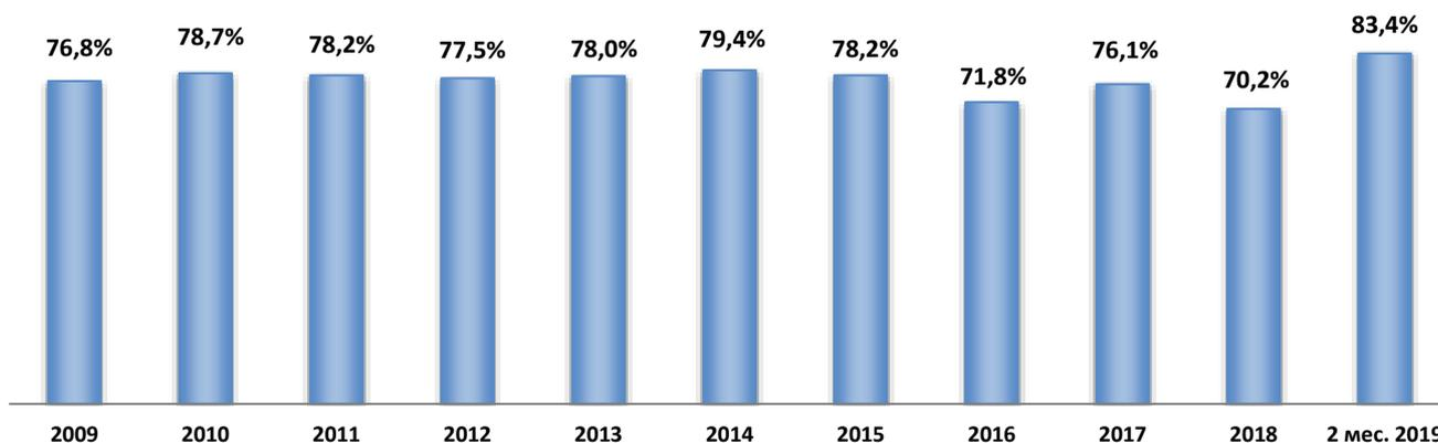
*Рис.5. Коэффициент готовности несения номинальной электрической нагрузки АЭС*
